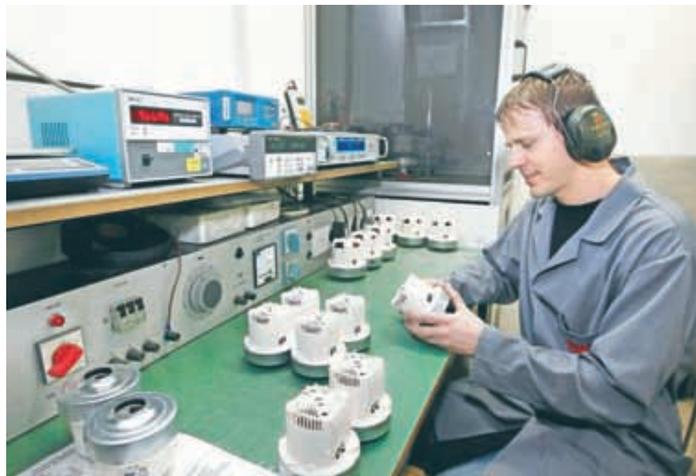
Matjaž Likar pri merjenju moči in izkoristka vzorčnega motorja / FOTO: GORAZD KAVČIČ
